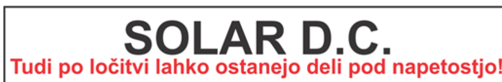
Slika 1: Primer nalepke za označitev kanala z vodniki enosmernega toka od PV do odklopnega stikala.
