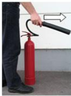
Cev usmerimo proti požaru
